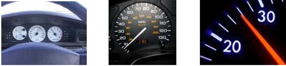
Gambar 2. 5. Spedometer menunjukkan kelajuan sesaat pada kendaraan bermotor
