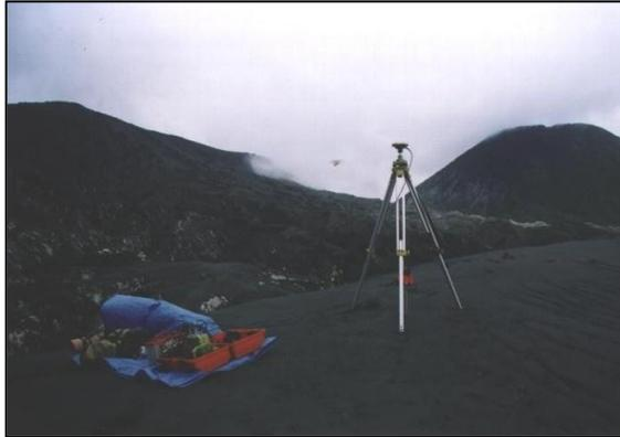
Gambar 3.17 Pengamatan perubahan bentuk (deformasi) gunungapi dengan menggunakan peralatan Global Positioning System (GPS)
