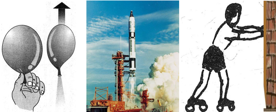
Gambar 11-9. Gaya aksi-reaksi pada balon, roket dan
