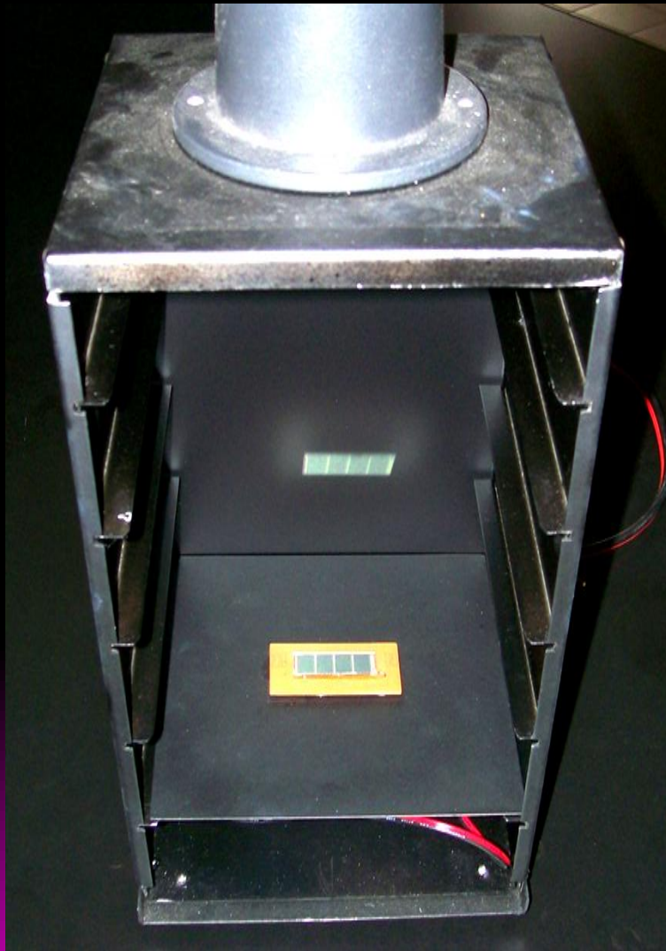
Gambar 4.1. Sistem pengukur karakteristik I-V sel surya
