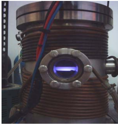
Gb.2. Plasma gas Argon pada saat penumbuhan Co-Fe di atas substrat Si(100)
