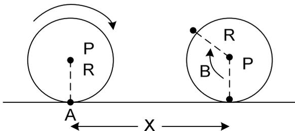
Gerak menggelinding merupakan kombinasi gerak rotasi terhadap pusat massa P dan gerak translasi dari pusat massa tersebut dari gambar hubungan besaran kinematika translasi pusat massa dengan kinematika rotasi adalah :
