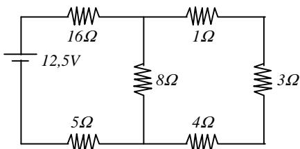
Rangkaian arus searah seperti pada gambar di atas. Beda potensial pada hambatan 4 ohm adalah.....
