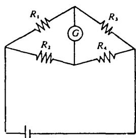
Pada percobaan dengan menggunakan alat ukur jembatan wheatstone pada rangkaian di samping ini, terlihat jarum galvanometer pada posisi nol, maka.....
