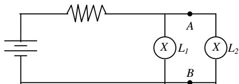
Lampu  $L_1$  dan  $L_2$  dipasang paralel dan dihubungkan dengan baterai E. Jika titik A dan B dihubungkan pendek (short circuit), pada lampu  $L_1$  dan  $L_2$  akan terjadi.....
