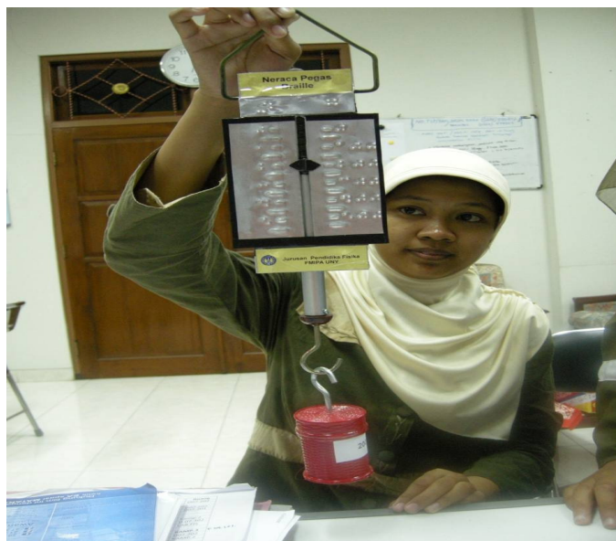
Gambar 1. Neraca Pegas Untuk Siswa Tunanetra dibuat oleh mahasiswa
