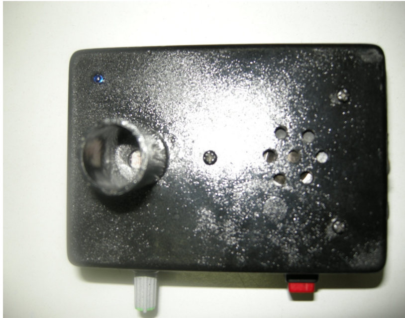
Gambar 3. Alat Penentu Titik Fokus Lensa dibuat oleh mahasiswa
