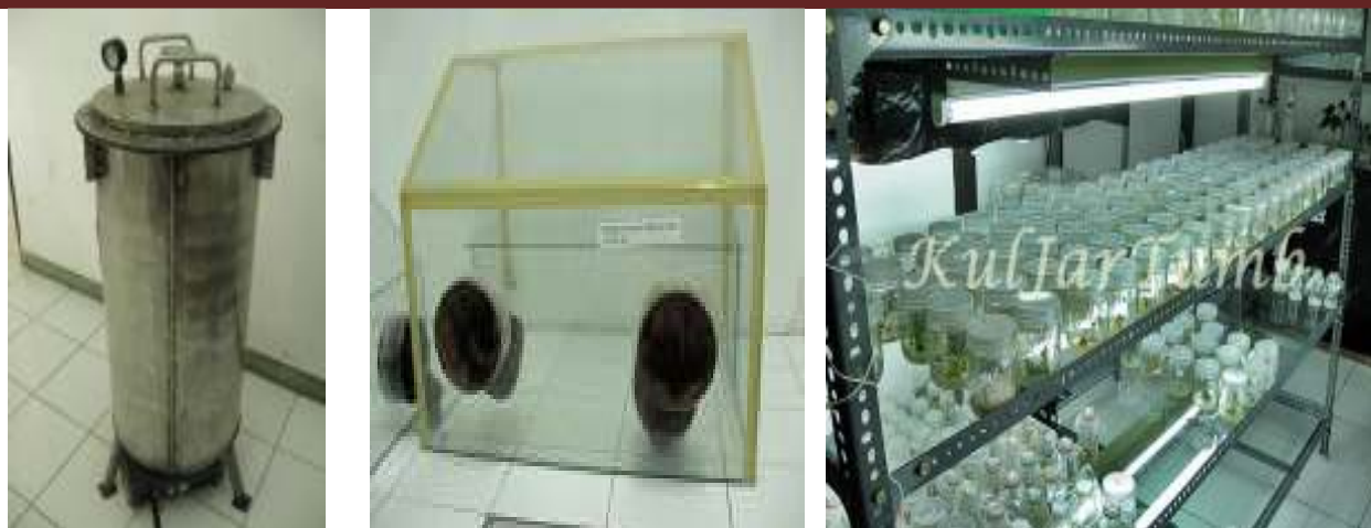
Gambar 1. Beberapa alat alternatif di laboratorium kultur jaringan tumbuhan di Jurusan Biologi FMIPA Unnes. Dari kiri ke kanan: autoklaf 'tiruan', entkas, dan rak kultur
