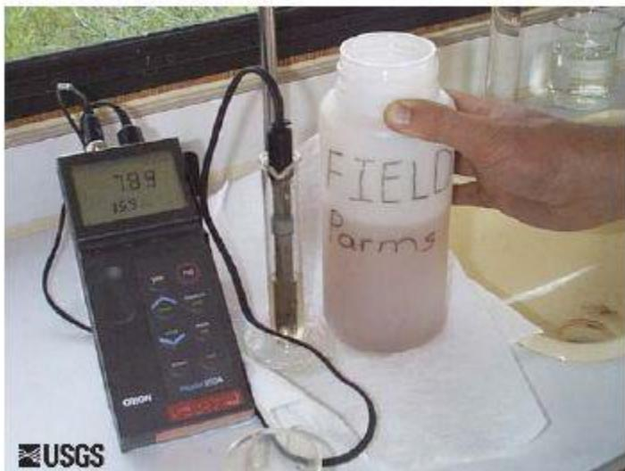
Gambar 3.22. Pengukuran pH dengan pH Meter
