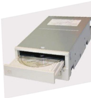
(1). CD ROM, adalah alat optic membaca inputan dari CD. Kekurangan dari alat ini adalah tidak dapat me-rewrite di CD (memasukkan data ke CD).
