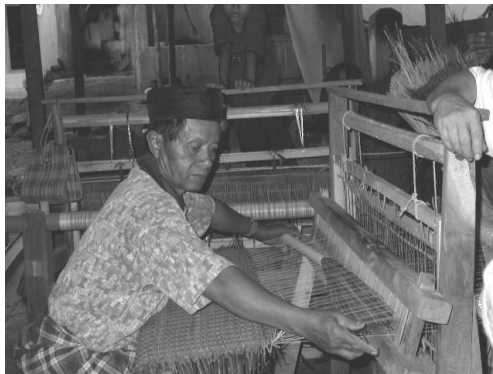
Serorang perajin sedang memasukkan pakan serat mendong pada alat anyam yang disebut tustel (Sumber foto: penulis)
