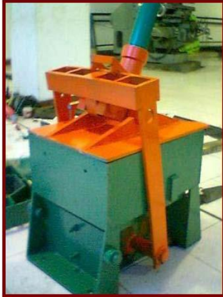
Gambar IV-16, Mesin Cetak Batako dan pemasangan batako Gambar IV-17, Industri Batako
