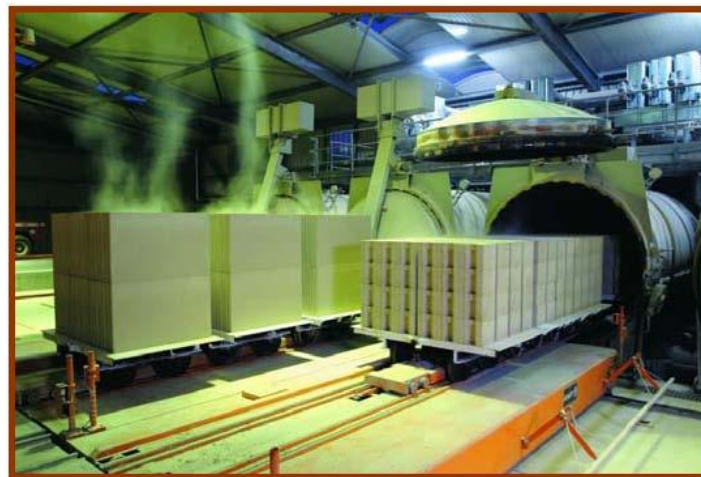
Gambar IV-10. Proses Pembuatan Bata Hebel
