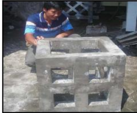
Gambar 4. Terumbu Buatan Bentuk Kubus Berongga dan Dimensinya
