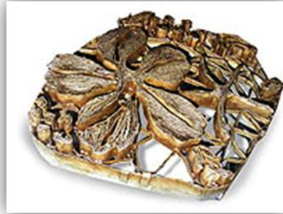
Tekstur alami berubah, berupa kertas yang dikusutkan, serta lempengan logam yang diukir dan disusun membentuk motif tertentu pada canting batik cetak
