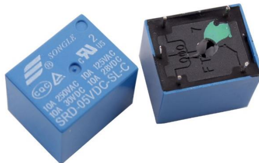
Gambar 2. Tampilan fisik relay 5V.
