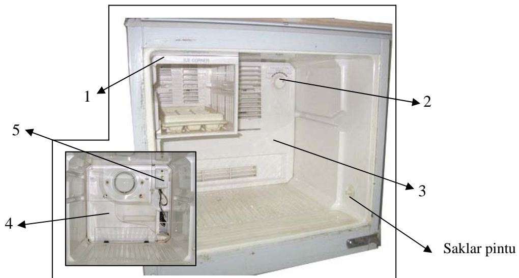
Gambar 4.13 Urutan melepas bagian yang menutup komponen sistem pendingin
