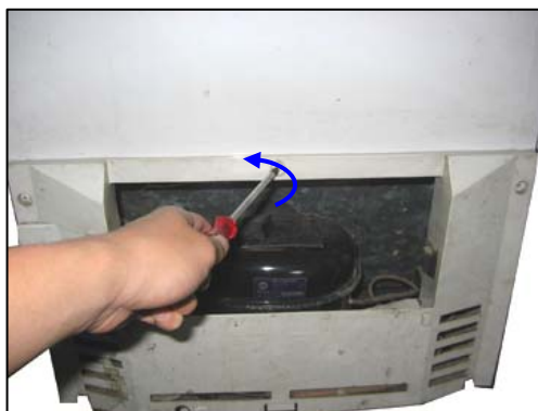
Gambar 4.25 Melapas bagian penutup, (a) membuka ikatan skrup, (b) melepas penutup
