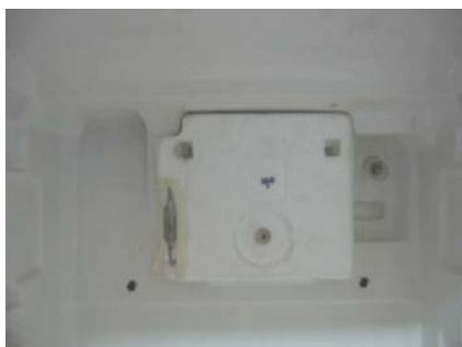
Penyetel suhu yang terlindung styrofoam
