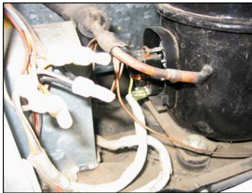
Gambar 4.27 Melepas penutup kotak terminal C, S, R pada kompresor
