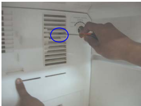
Gambar 4.16 Membuka pengunci yang mengikat bagian ventilasi
