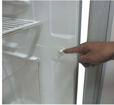
Gambar4.21 Saklar pintu pada ruang cool room
