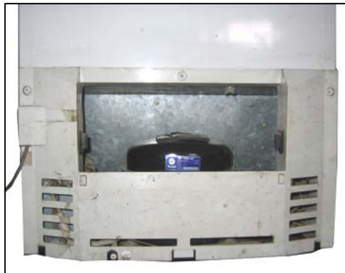
Gambar 4.24 Letak komponen sistem pendingin di bagian belakang lemari es
