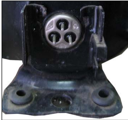
Gambar 4.31 Terminal C, S, R kompresor
