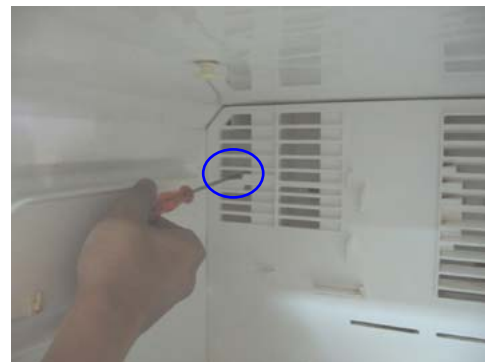
Gambar 4.16 Membuka pengunci yang mengikat bagian ventilasi
