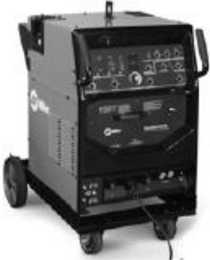
Power source jenis ini kebanyakan menggunakan arus DC untuk pengelasan dengan input power AC
