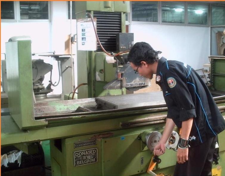
Setting daerah kerja dari *work table* jangan terlalu jauh antara ukuran benda kerja dengan daerah kerja dari *work table*
