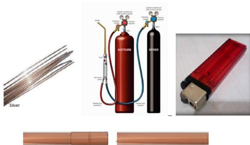
Gambar 1.14. Bahan-bahan yang dibutuhkan untuk brazing .
