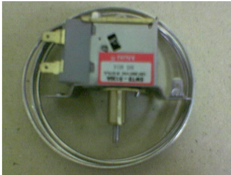
Gambar 12. Thermostat yang biasa digunakan pada AC mobil
