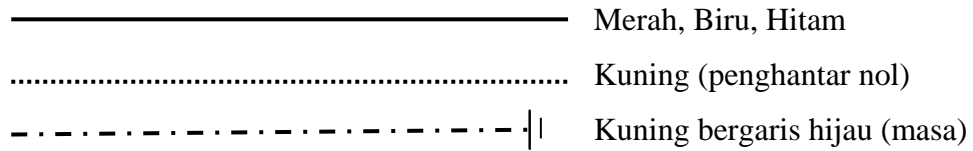
Gambar 4. Warna kabel dan cara penggambarannya.
