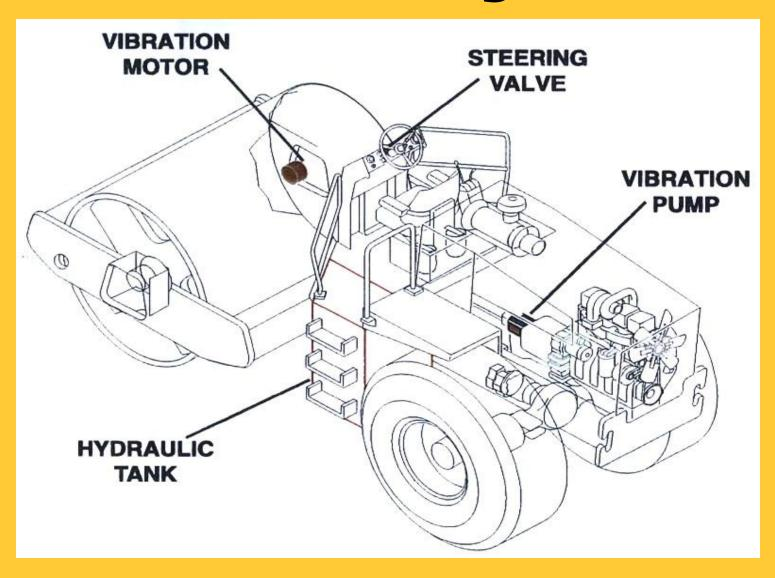
**VIBRATION SYSTEM HYDRAULIC TANK** VIBRATION PUMP B CASE SUCTION **VIBRATION MOTOR** FROM STEERING **VALVE RETURN OVERVIEW**
