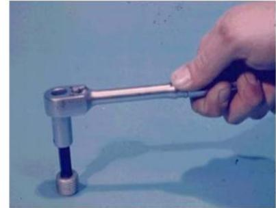
Tool ini biasa digunakan untuk membuka, memasang, atau menguatkan semua ukuran socket head screw dimana cukup ruangan untuk mengerjakannya.
