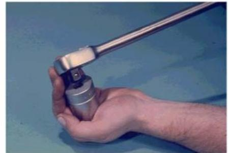
arah putaran pada head. Standard ratchet terdiri dari ukuran dan bentuk yang berbeda-beda untuk penggunaan yang berbeda-beda pula, terdiri dari swivel head, long handle, short handle, dan bent handle swivel head. Ratchets dipasang dengan drive sockets untuk melepas dan memasang komponen pengikat di semua penggunaan yang cukup ruang.
