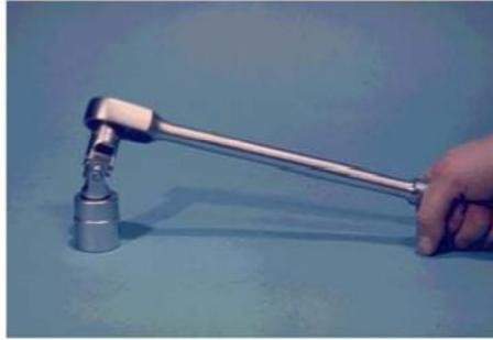
Universal joint terdiri dari internal drive socket dan external lug dan pivot block dibagian tengah. Yokes terpasang pada pivot block dan
