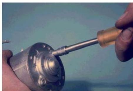
Socket drive seperti screwdriver disamping untuk memasang ujung obeng, tool ini dipergunakan untuk memasang dan melepas nut
