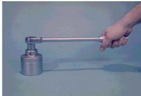
Drive adaptor tampak seperti extension pendek yang terdiri dari drive hole dan drive lug. Tool digunakan untuk menyambung ratchets dan
