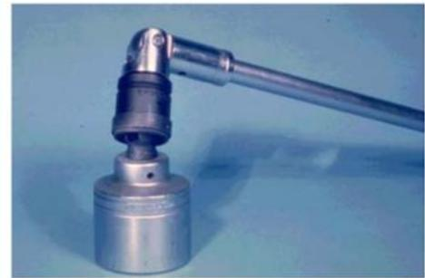
internal drive lug hole pada salah satu sisi, external drive lug dan drive pin pada sisi lainnya. External drive lug memiliki ball stud dengan slot berbentuk oval tempat drive pin duduk. Celah extra antara drive pin dan drive pin slot pada external drive lug memungkinkan universal drive dipergunakan membentuk sudut. Tool ini dapat dipergunakan pada area yang tidak dapat dijangkau oleh wrench/ spanner atau socket dan handle.
