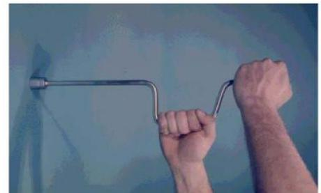
Tool ini memiliki sisi berbentuk huruf U-yang dioffset dari tengah, yang berfungsi sebagai handle untuk memutar socket. Jangan pukul tool ini dengan palu. Pegang rotating handle dengan aman dan tahan dengan baik sejajar dengan nut atau bolt. Jangan pergunakan tool ini sebagai pry bar (pengungkit).
