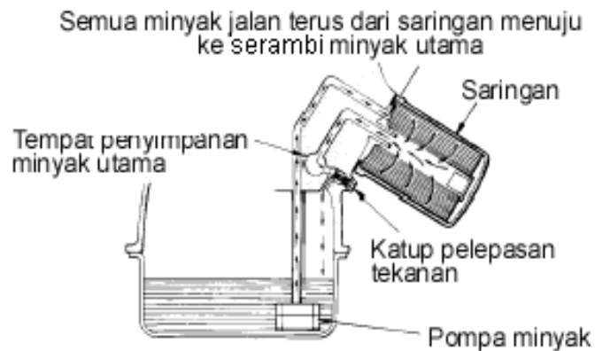
Gambar : 4 Saringan Oli Aliran Penuh.
