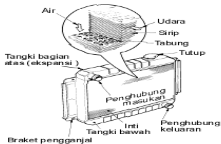
Gambar 3 Radiator aliran naik
