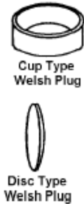
Gambar 13 Dua macam Welsh plug, tipe gelas dan tipe piringan
