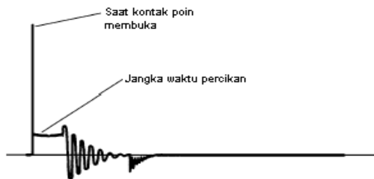
Gambar 2. Osiloskop Pola bentuk gelombang Sekunder tunggal
