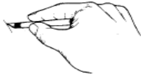
Gambar 26. Pegang pisau seperti memegang pensil atau pulpen
