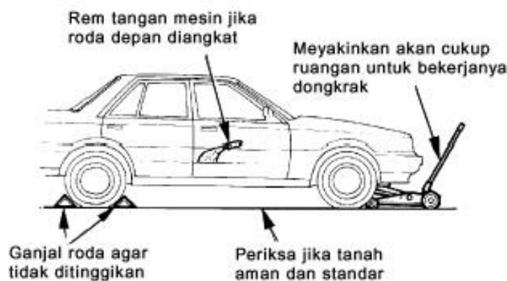
Gambar 21. Ikuti prosedur keselamatan sewaktu mendongkrak
