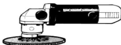
*Gambar 17. Sander/Mesin Pengampelas cakram orbital listrik*
