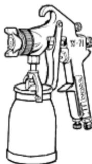
Gambar 30. Alat penyemprot jenis penyedotan
