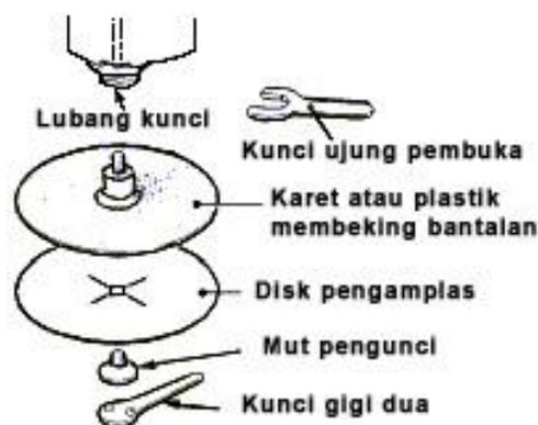
Gambar 11. Bagian-bagian cakram Sander/Mesin Pengampelas (bantalan keras).
