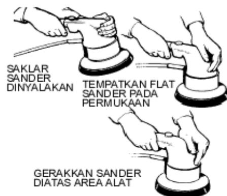
*Gambar 18. Penggunaan Mesin Pengampelas cakram orbital*
