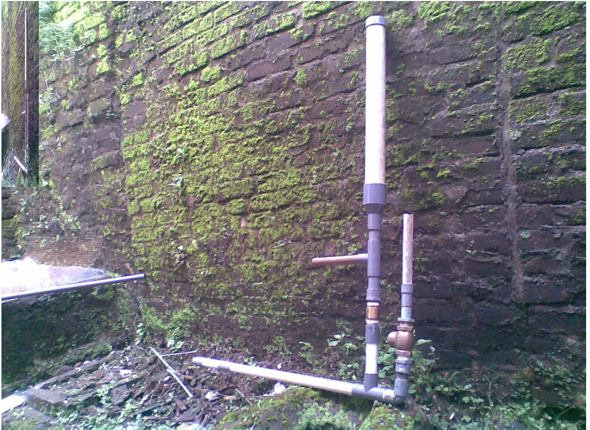
Gambar 2. Pompa Hidram Setelah Dirakit
