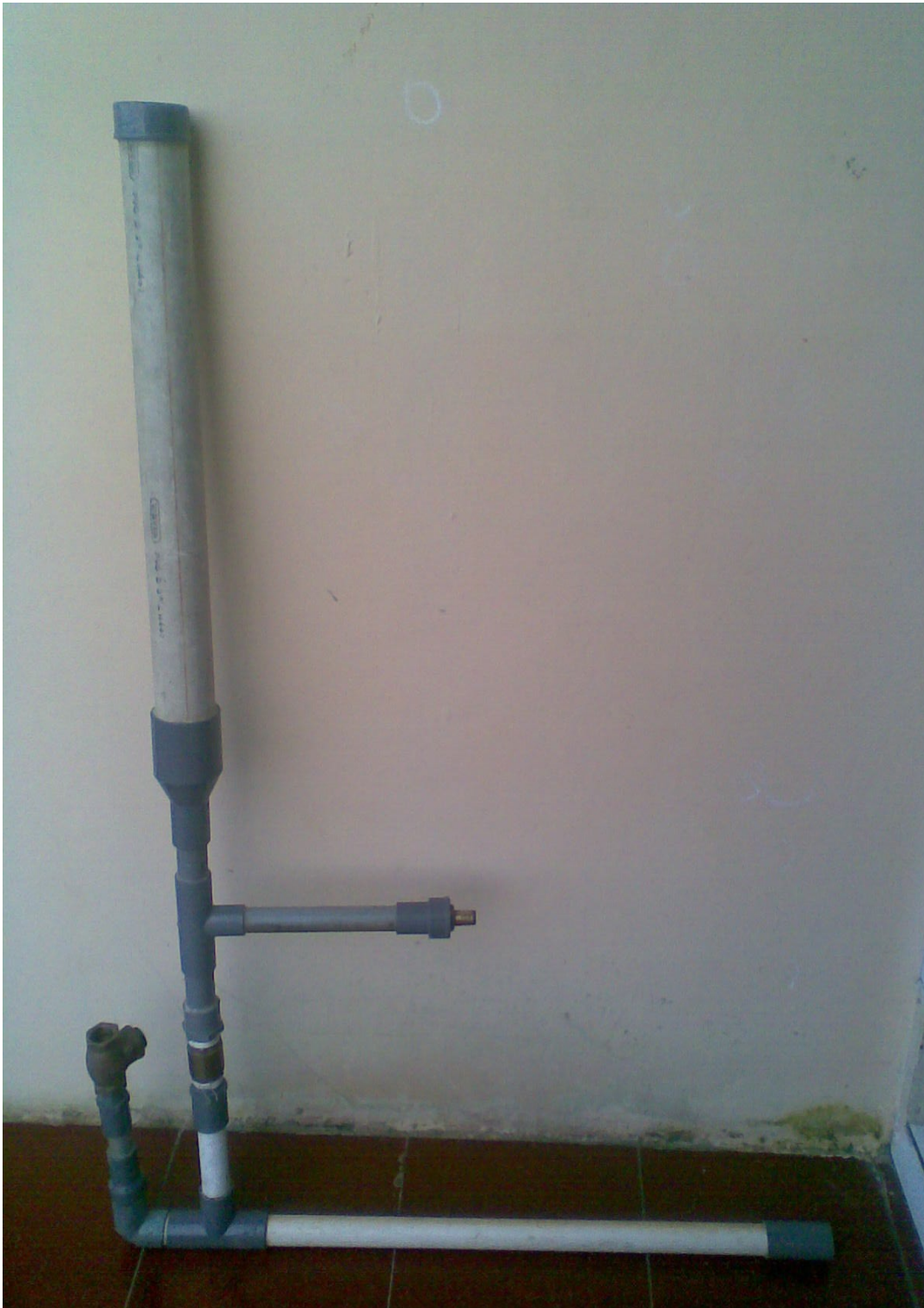
Gambar 1. Pompa Hidram Setelah Dirakit
